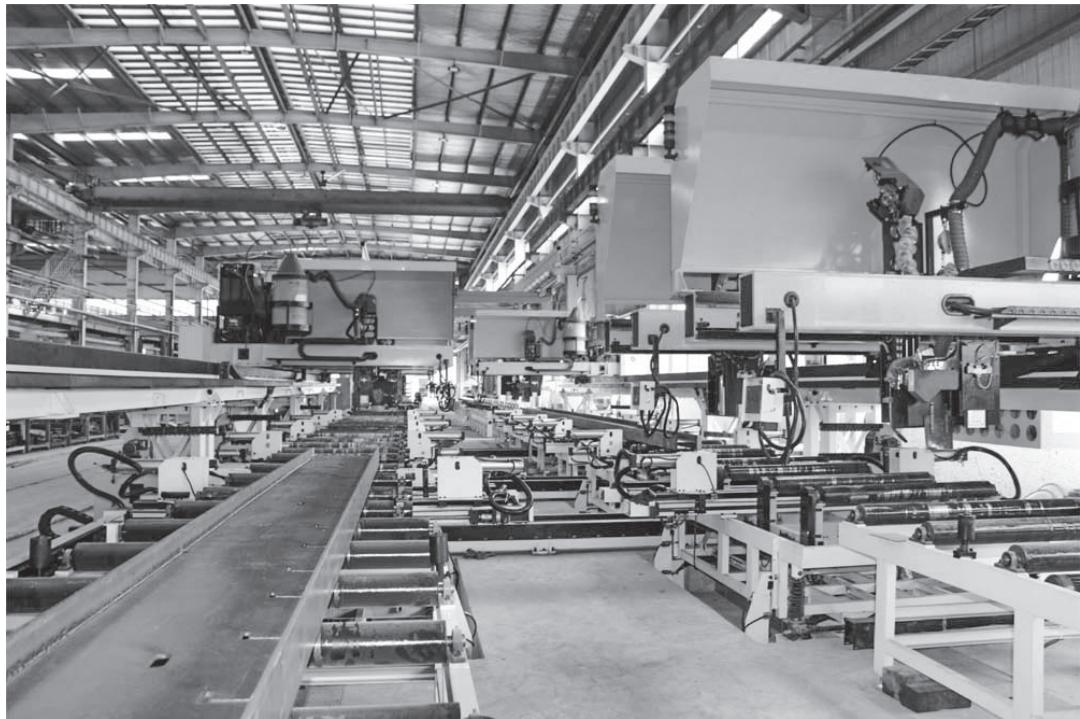
◎ 水泊焊割新型大梁焊接生产线
